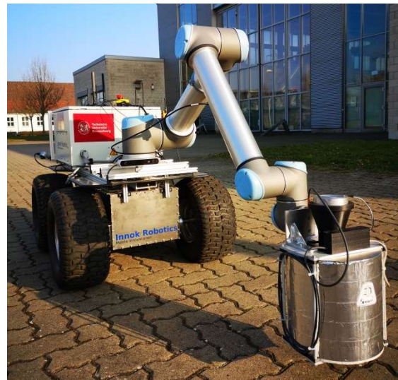
MIRA3D mit Roboterarm und Druckkopf-Dummy
