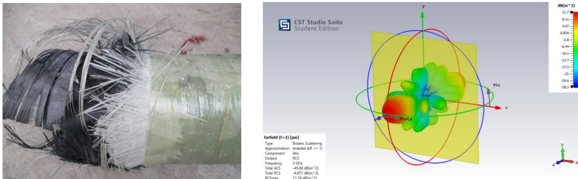
Abbildung 1: Explodierter Gastank mit innerer Kohlefaserverbundstruktur (links). Elektromagnetische Simulation einer Platte (rechts).
